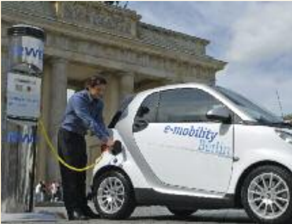
Tanken, wenn der Wind weht: Mit den IKT-Lösungen von E-Energy kann die Batterie des Elektrofahrzeugs dann geladen werden, wenn es günstigen Strom aus erneuerbaren Energien gibt.
