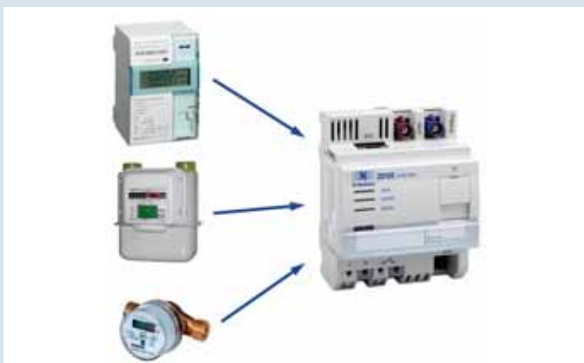
Abb. 1 Zähler übertragen ihre Daten via M-Bus-Schnittstelle zur Kommunikationseinheit (MUC-Controller) Quelle: RWE Deutschland AG
